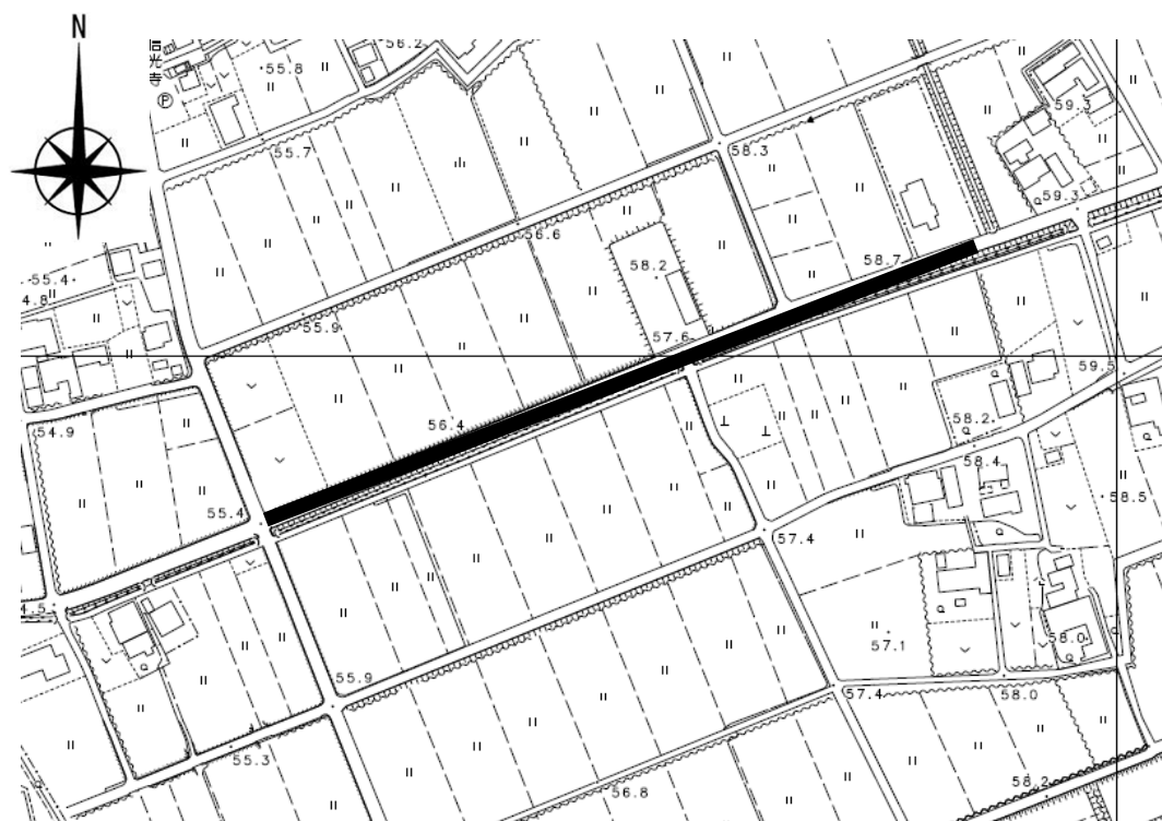
①町道川北口南場線 施工延長 335m 幅員 6.0m
