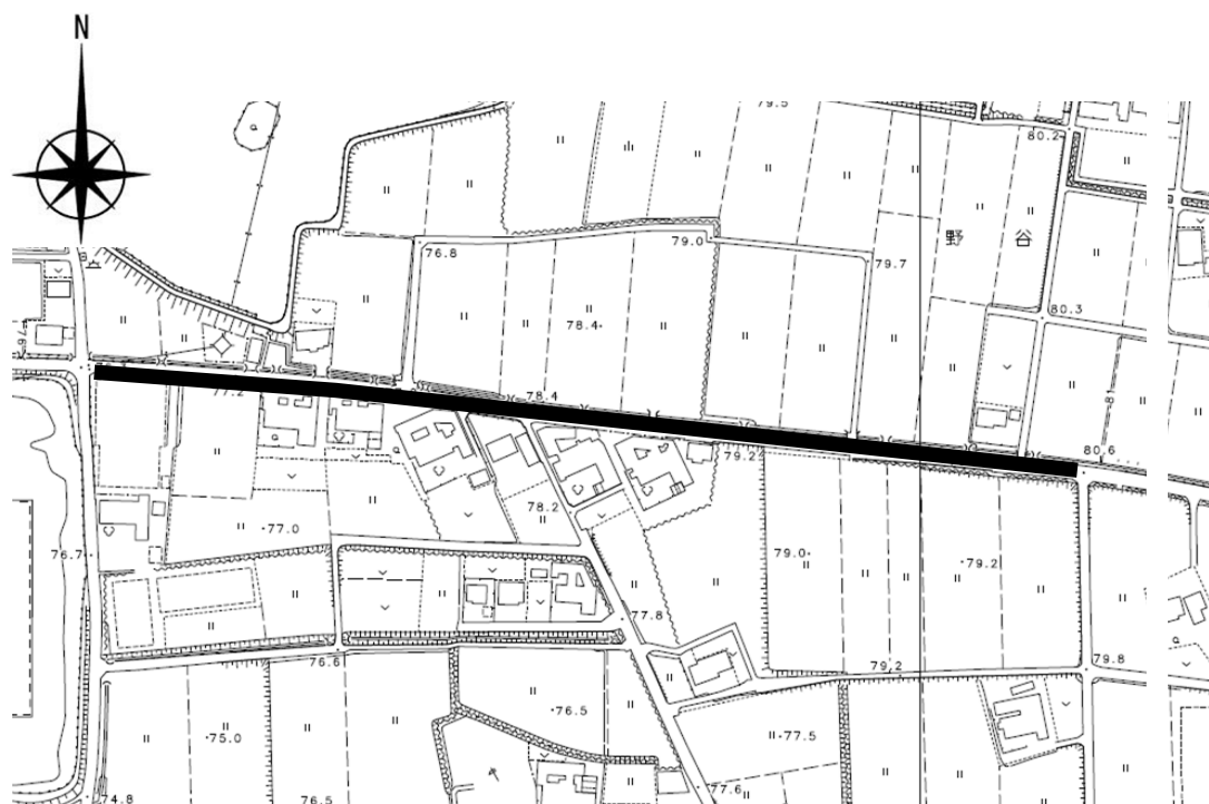
②町道至子線 施工延長 600m 幅員 6.0m
