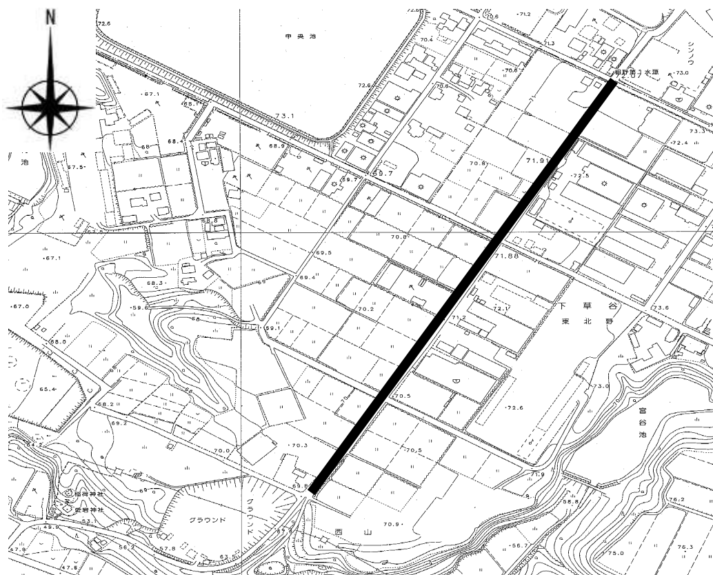
①町道下草谷飛行場線 施工延長 600m 幅員 6.5m
