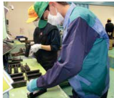
▲ゴム板の型抜き(ニッタ化工品株式会社)
