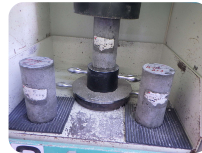
きょうしたい あっしゅくきょうどしけん ようす 供試体の圧縮強度試験の様子
